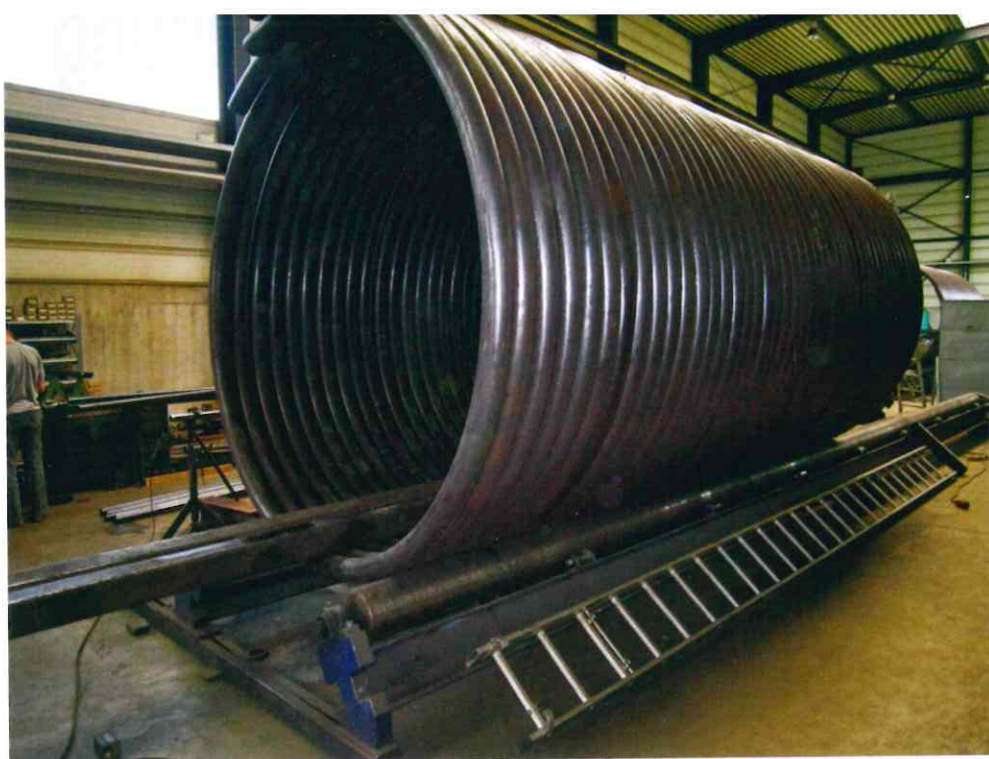
Imagen de la construcción de la caldera de aceite térmico que cederá 27.700 kW térmicos
