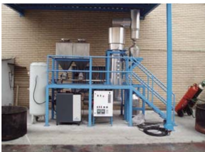
Figura 9. Planta experimental de gasificación en lecho fluidizado
